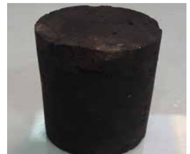
مغزه یا سنگ مخازن کربناتی جنوبی کشور مورد استفاده برای تست آشام خود به خودی
